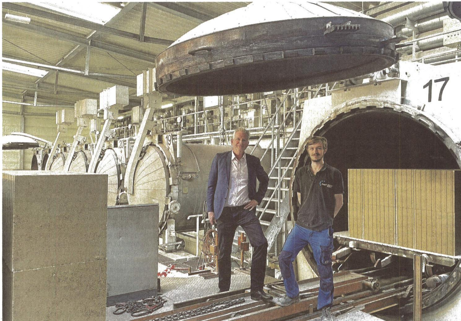
Dr. Hannes Zapf mit einem Mitarbeiter aus der Produktion vor einem der großen Dampf-Härteessel des Kalksandstein-Unternehmens. Bei etwa 200 Grad Celsius werden die Rohlinge unter Wasserdampfdruck sechs Stunden lang gehärtet.
